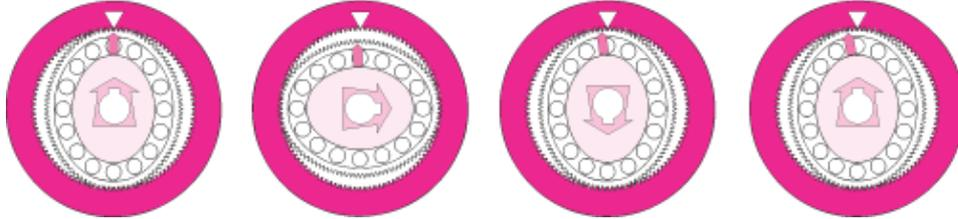
Abbildung 5.8: Darstellung der Funktion des Harmonic Drive Getriebes durch vier Motorpositionen. Quelle: [HD08]
