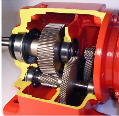
Abbildung 5.5: Das Bild zeigt ein dreistufiges Stirnradgetriebe mit, für einen ruhigen Lauf sorgenden, schrägverzahnten Stirnrädern. Auf der rechten Seite befindet sich der Motor mit einem kleinen Ritzel und auf der linken Seite ist das große Abtriebsrad zu sehen. Quelle: [Get08]
