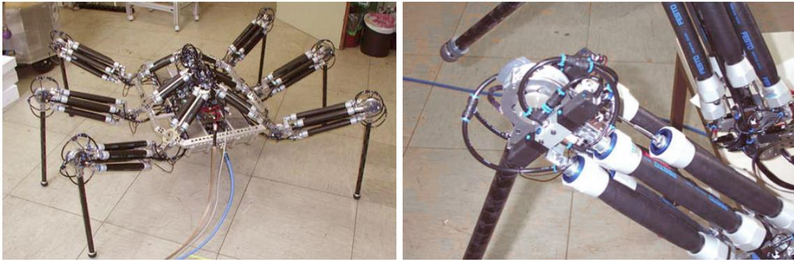
Abbildung 3.5: Links: Sechsheiniger Laufroboter namens AirBug, ausgerüstet mit pneumatischen Muskeln. Quelle: [KAB02]
