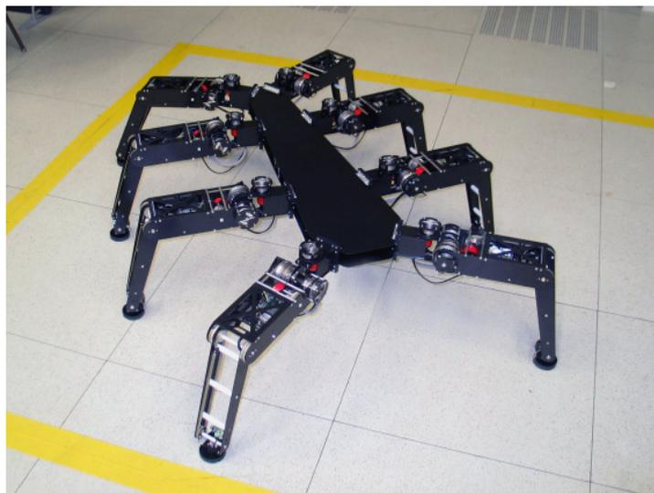
Abbildung 3.1: Achtbeiniger Laufroboter namens *Oktavio* in Ruheposition bzw. M-Stellung.
